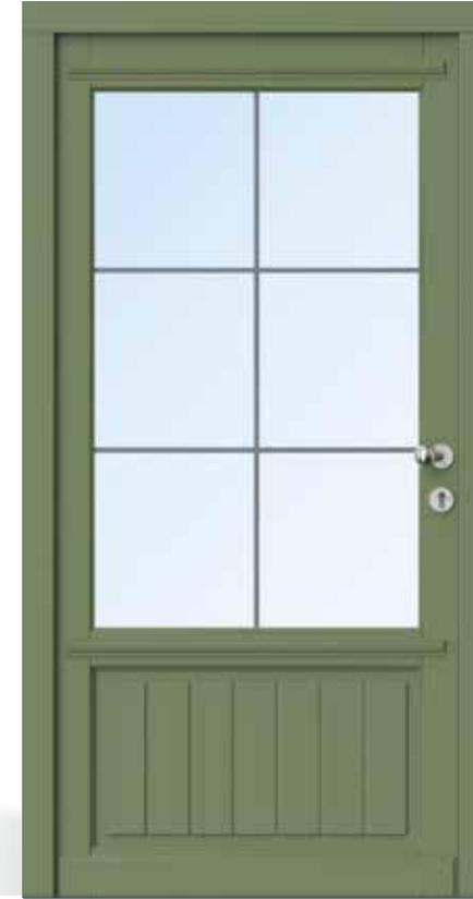
**AH 94116** • Rahmenkonstruktion • Holzart Kiefer • Resedagrün RAL 6011 • Karniesprofil am Flügel • Aufbauprofil 40 mm oben • eine waagerechte glasteilende Sprosse 98 mm • oben Glasfeld mit Bleisprossen 12 mm glatt • unten Brüstungsplatte als Einsatzfüllung • außen senkrecht genutet • zwei Zierprofile außen • mit Holzwetterschenkel • S2150 Edelstahl-Knauf
