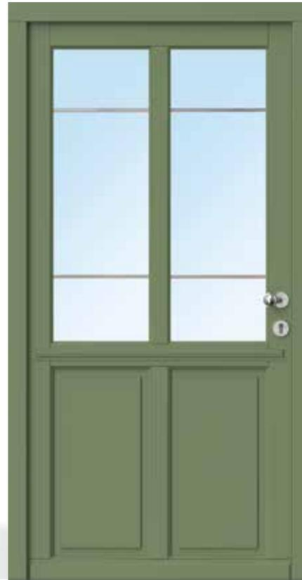
**AH 94309** • Rahmenkonstruktion • Holzart Kiefer • Resedagrün RAL 6011 • Karniesprofil am Flügel • eine waagerechte glasteilende Sprosse 98 mm • senkrechte glasteilende Sprosse 78 mm • oben Glasfelder mit Bleisprossen 12 mm glatt • unten Brüstungsplatten als Einsatzfüllung, außen mit flacher Kassette, Zierprofil außen • mit Holzwetterschenkel • S2150 Edelstahl-Knauf
