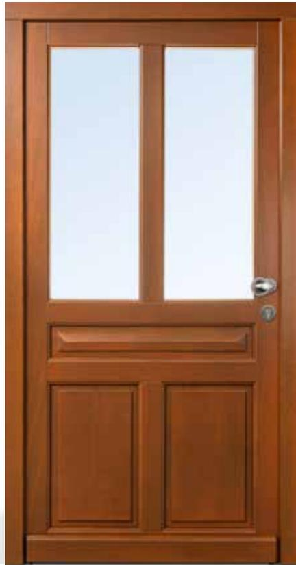
**AH 94429** • Rahmenkonstruktion • Holzart Kiefer • Lasur Afrormosia 625 • Karniesprofil am Flügel • glasteilende Sprosse 98 mm • oben Glasfelder • unten Brüstungsplatten als Einsatzfüllung mit Zierprofil bzw. flacher Kassette außen • mit Holzwetterschenkel • S2150 Edelstahl-Knauf
