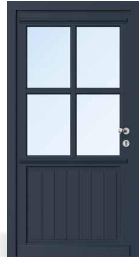
**AH 94419** • Rahmenkonstruktion • Holzart Kiefer • Stahlblau RAL 5011 • Karniesprofil am Flügel • Aufbauprofil 40 mm oben • eine waagerechte glasteilende Sprosse 98 mm • oben Glasfeld mit 54 mm glasteilendem Sprossenkreuz • unten Brüstungsplatte als Einsatzfüllung • außen senkrecht genutet • zwei Zierprofile außen • mit Holzwetterschenkel • S2150 Edelstahl-Knauf
